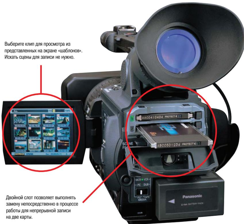
Двойной слот позволяет выполнять замену непосредственно в процессе работы для непрерывной записи на две карты.
