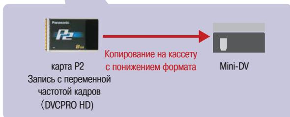
Запись с переменной частотой смены кадров на карту P2 с последующей передачей на пленку DV для получения скоростных эффектов на обычном оборудовании DV.
