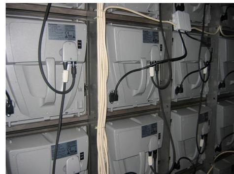
• Комплексная конфигурация, включающая встроенный источник питания и элементы на пружинных защёлках, обеспечивают простоту технического обслуживания;
